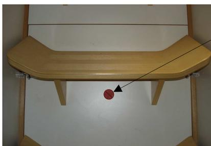
Orifice pour buse d'extincteur compartiment moteur
