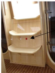
Orifice pour buse d'extincteur compartiment moteur
