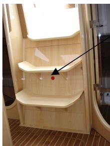
Orifizio per l'ugello dell'estintore nel comparto motore
