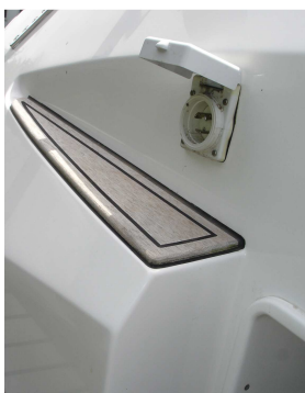
Toma de muelle en la falda trasera a babor
