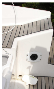
Bomba de sentina manual estribor en caseta del timón
