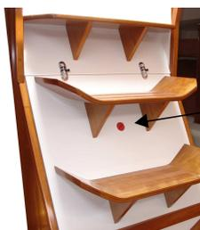
Orifice pour buse d'extincteur compartiment moteur
