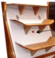
Orifizio per l'ugello dell'estintore nel comparto motore
