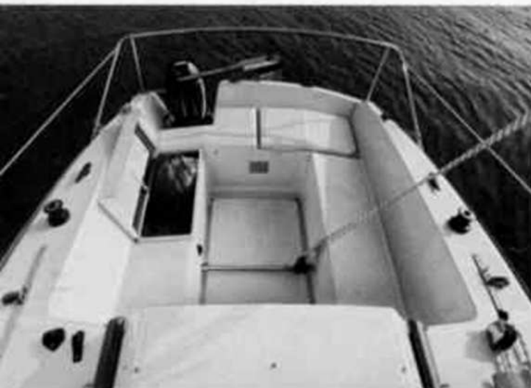
Un cockpit intelligent : pour gagner de la place, la barre d'écoute (en série) est fixée au plancher. Une découpe dans le tableau arrière reçoit à demeure le moteur hors-bord. Le coffre arrière est décalé.
