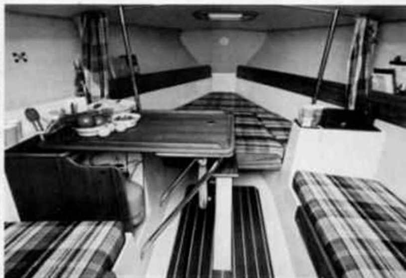
De l'espace et de vastes rangements, mais aussi des tissus chaleureux. La table du carré pivote vers l'arrière. En version dériveur, le relevage de la dérive par enrouleur (sous la table) est aisé.
