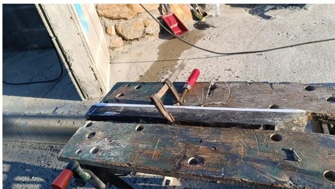
Après prise se la colle( une nuit), j'ai collée au sika à sa place dans la rainure du puit de dérive et maintenu avec la dérive haute
