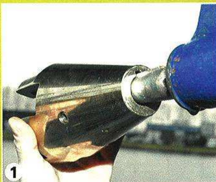
1 ▲ On engage le moyeu sur le cône de l'arbre, avec sa clavette dans l'encoche ad hoc.
