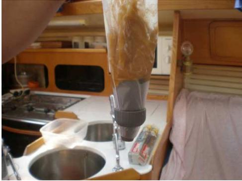
Figure 6 : poche de pâtissier pour repousser la choucroute, sous la cloison, sinon utiliser " un coffrage"
