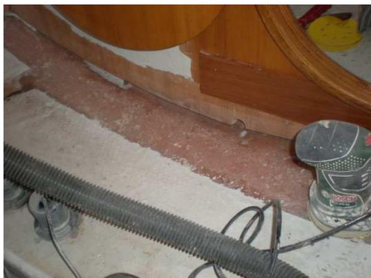
Figure 5 : Fin du ponçage, le bois et le stratifié de la coque sont à nu.
