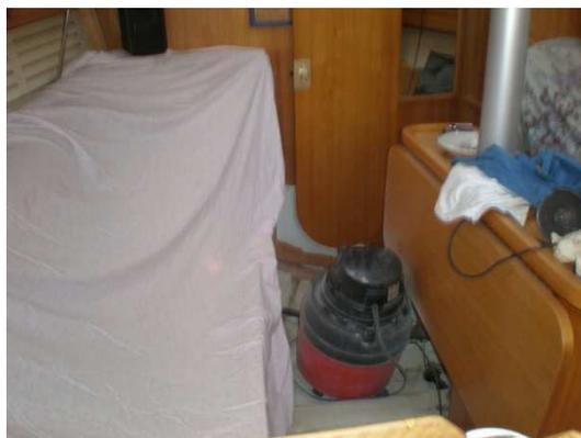
Figure 4 :L'aspirateur est tout ce que j'ai trouvé pour limiter la diffusion de la poussière mais ce n'est pas suffisant, préférer une ponceuse girafe, avec le tuyau d'aspiration relié à la ponceuse.
