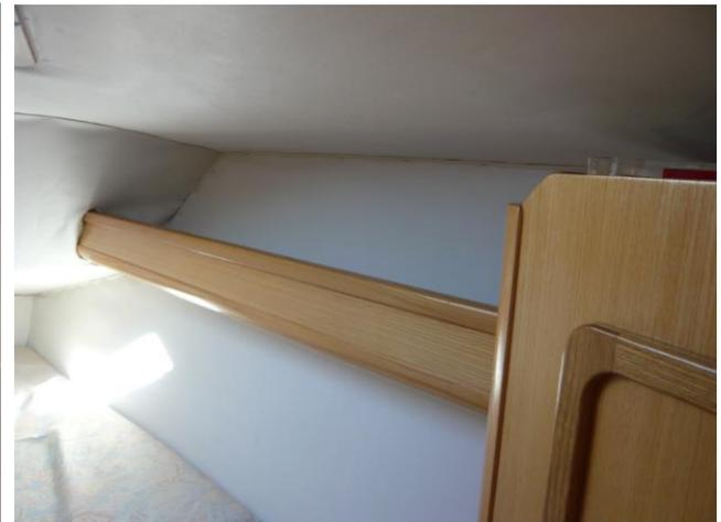
Mise en place de baguette en hêtre pour masquer les agrafes
