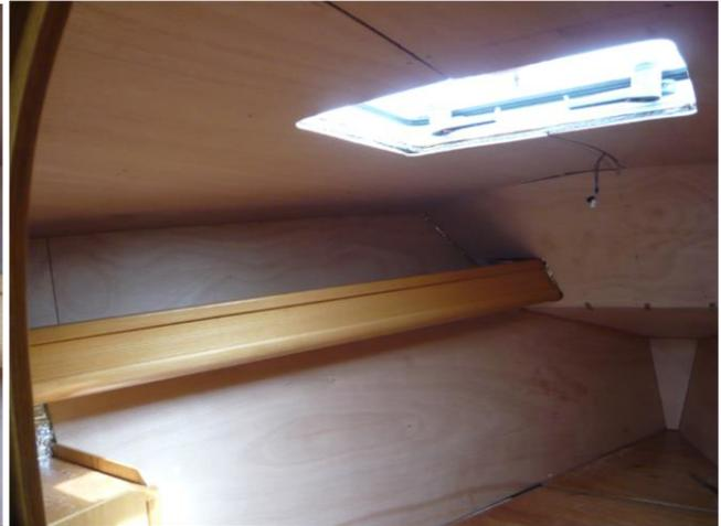
Les panneaux du plafond ont été réalisés en deux parties pour permettre l'introduction et la mise en place
