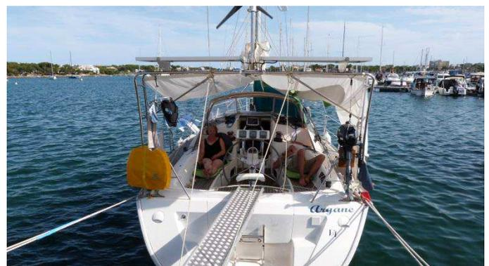
**Elle est pas mal ma passerelle ! Echelle alu recouverte d'une tôle alu + 2 roulettes...**
