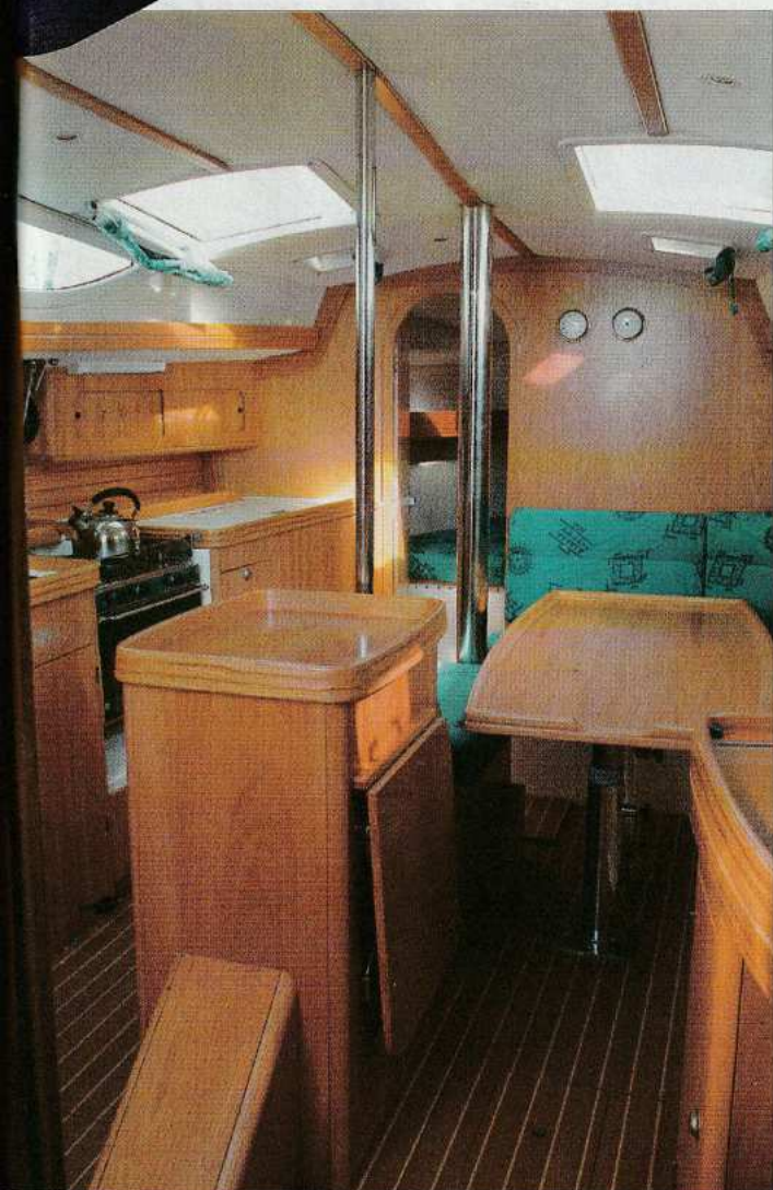
La tablette amovible du meuble central, ici en position repliée, peut prolonger la table du carré. En bas à gauche, on voit l'arrière du puits de dérive qui gêne la circulation.
