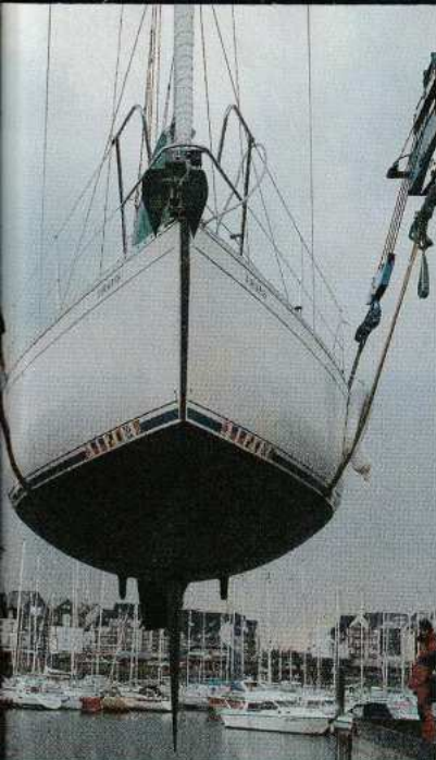
La semelle de fonte, avec ses deux quillettes de soutien, comporte l'essentiel du lest.
