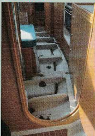
Dans les fonds, pas de contre-moule : les varangues sont en bois massif stratifié.
