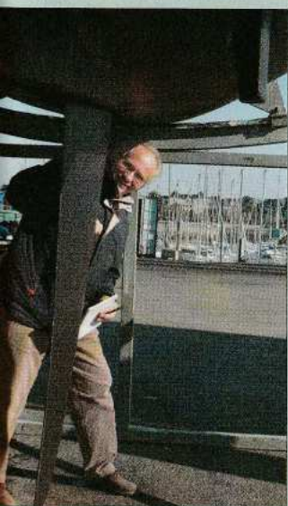
La dérive a un peu de jeu. Rien d'alarmant, mais c'est un point à surveiller.
