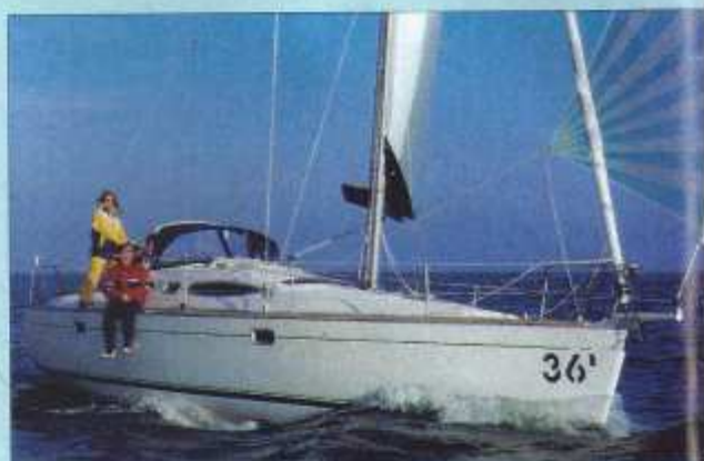
Fixé dans la ferrure d'étrave, le bout-dehors en aluminium permet de porter un spi asymétrique.
