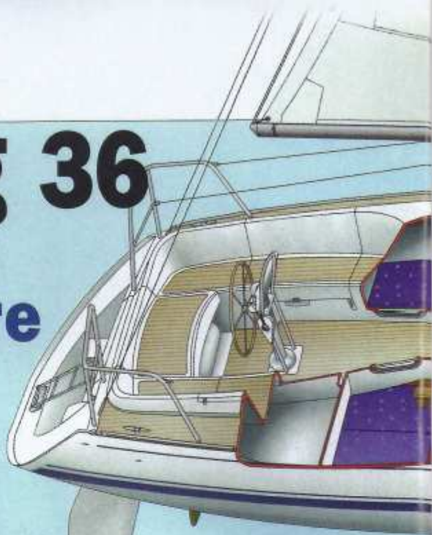
Le bloc central caractéristique de la version dériveur assure un solide point d'ancrage pour les déplacements à bord.
