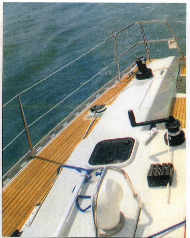
▲ Les winches de génois ont été positionnés à portée de main du barreur.
