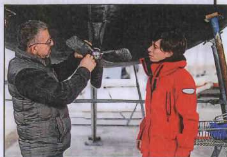
▲ L'hélice est propre. Seules les pâles sont marquées par une petite usure à leur base.
