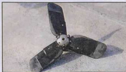
▲ Nettoyée et remontée, l'hélice est prête à repartir pour une décennie de loyaux services. Elle est dotée des nouvelles pales amincies et des ergots désormais asymétriques.
