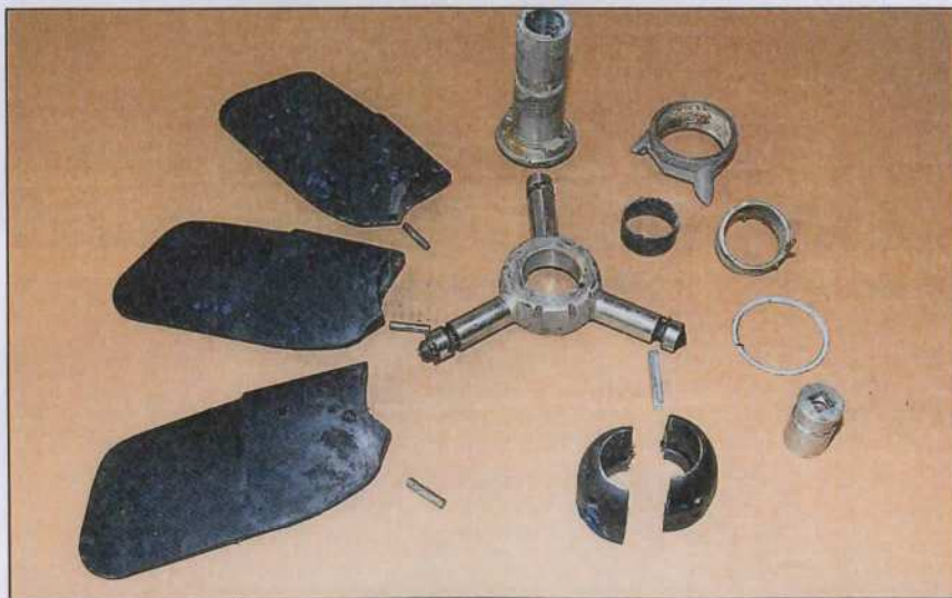
▲ Démontée, elle se compose d'une quinzaine d'éléments en acier inoxydable ou en composite. Les pales montées sur leur propre axe sont indépendantes les unes des autres.
