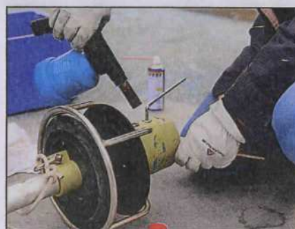
▲ Chauffé, frappé, le démontage musclé de l'enrouleur témoigne de l'usure de l'ensemble.
