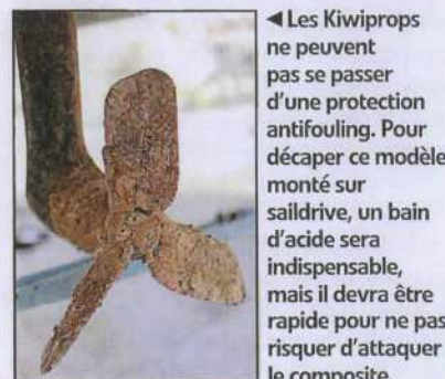
▲ Remontage express puisque cette hélice se passe d'anode.
