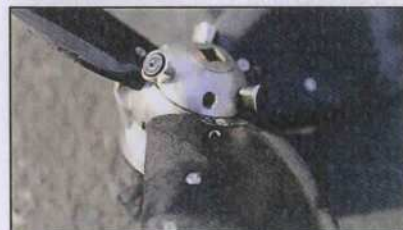
▲ Le pas se règle en tournant ces vis du même nombre de tours (1/4 ou 1/3).
