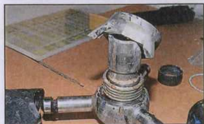
▲ Le ressort assure la mise en drapeau des pales, et sert d'amortisseur lors de l'enclenchement de la transmission. Faute de graissage, il est ici recouvert de concrétions.
