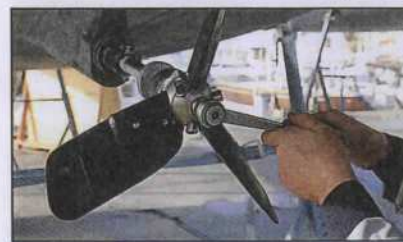
▲ Remontage express puisque cette hélice se passe d'anode.
